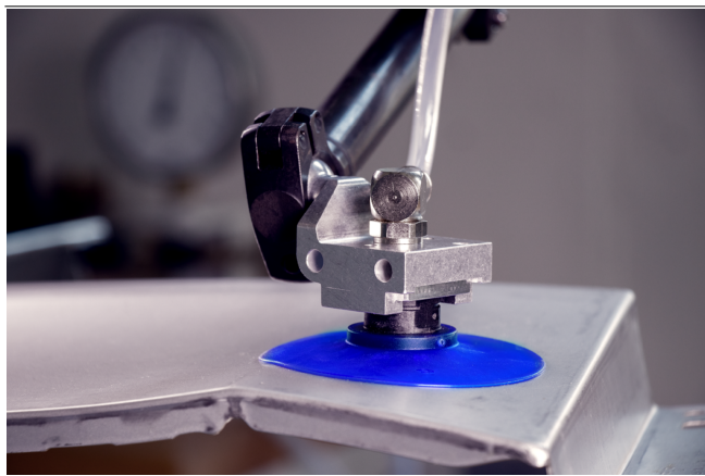
Держатели для вакуумных захватов НТ-SG в сочетании с колокольными вакуумными захватами SAX при обращении с деталями из листового
